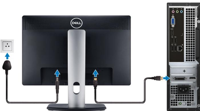
**i** 注：如果您的计算机仅附带集成显卡，则将显示器连接至背面板上的显示器端口。
