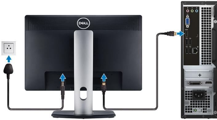
4. 首先，将电源线连接至计算机，然后连接至电源。
